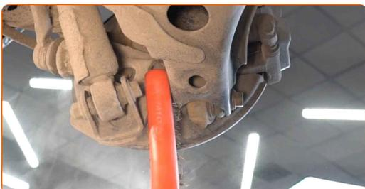
**8** Înșurubați elementul de fixare inferior al amortizorului. Utilizați o cheie tubulară №17. Folosiți o cheie cu clichet.
