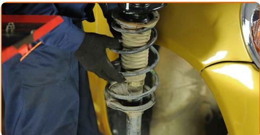
**30** Curățați locurile de montare ale telescopului amortizorului. Folosiți o perie de sârmă. Folosiți spray WD-40.
