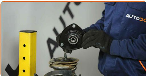
**25** Strângeți șurubul tije pistonului barei de sprijin amortizor. Utilizați o cheie tubulară №17. Folosiți o cheie de cuplu. Strângeți pînă la cuplul de 33 Nm.
