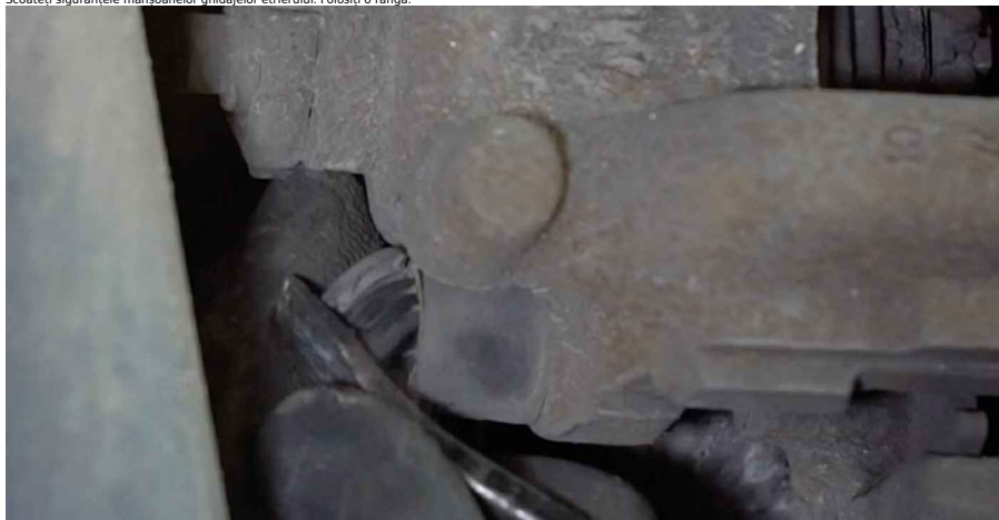
12 Desurubiți fixarea etrierului de frână. Folosiți cheia hexagonală nr. H7. Folosiți o cheie cu clichet.
