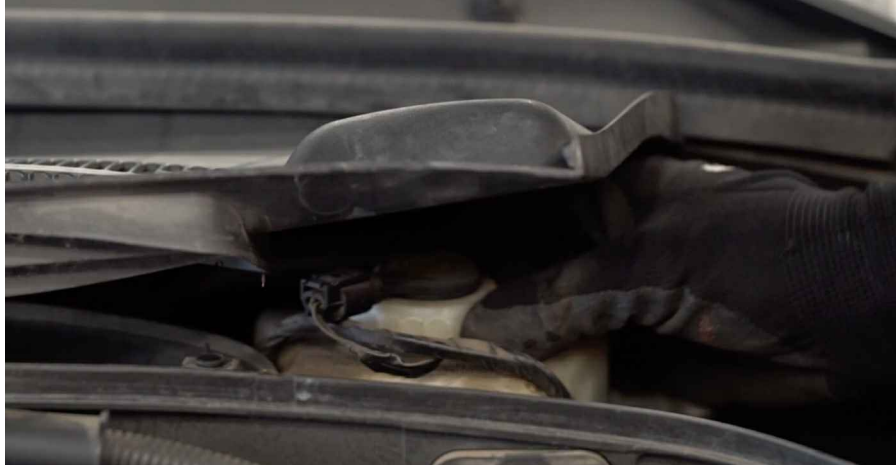
31 Instalati panoul de protectie.
