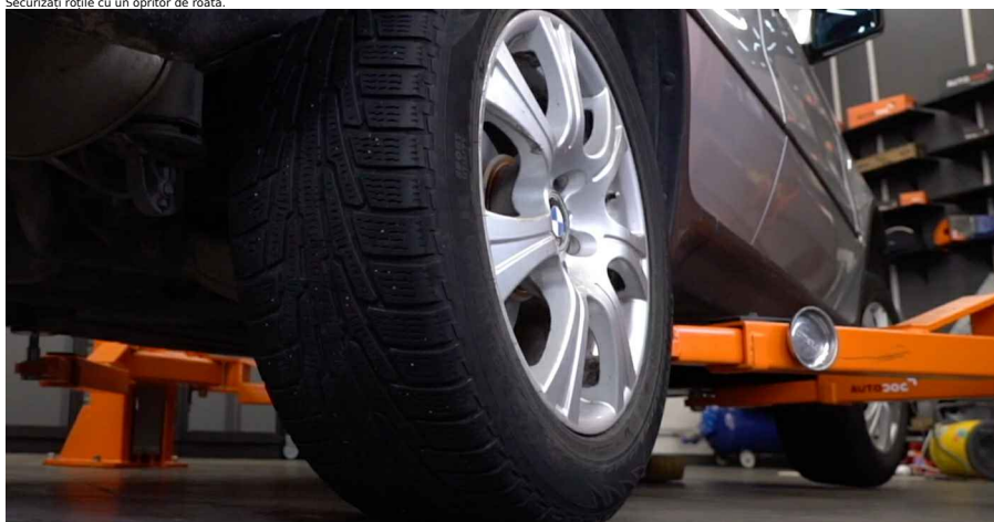
6 Slăbiți șuruburile de fixare a roții. Folosiți o cheie tubulară de impact pentru roată #19.
