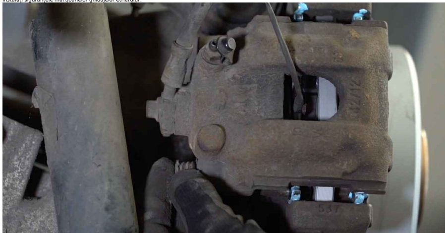
24 Montati arcul de fixare a etrierului de frână.
