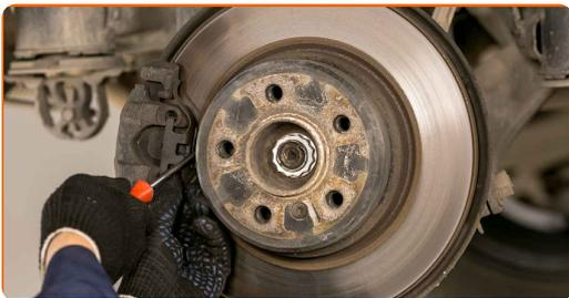
**8** Deconectați cablul senzorului de uzură a plăcuțelor de frână.
