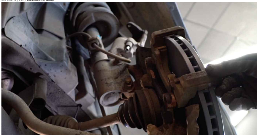
26 Strângeți suportul etrierului de frână. Utilizați o cheie tubulară N:16. Folosiți o cheie de cuplu. Strângeți pînă la cuplul de 110 Nm.
