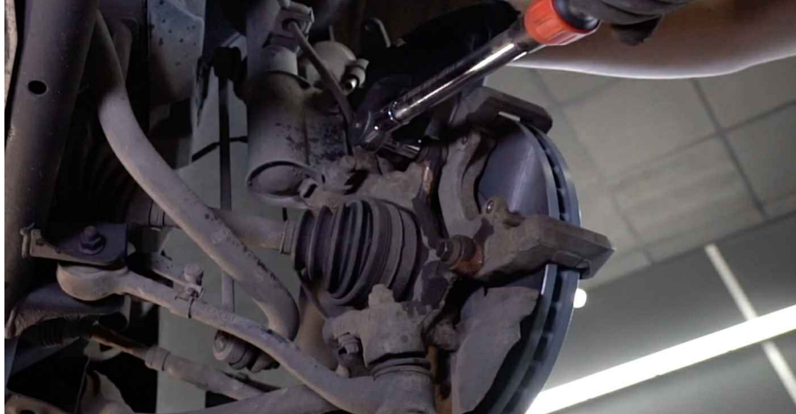
27 Apăsati pistonul etrierului de frână. Folositi o presă pentru etrier de frână.
