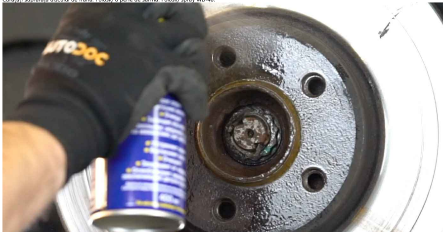
20 Desurubiți fixarea discului de frână. Folosiți Torx T30. Folosiți o surubelniță de impact.
