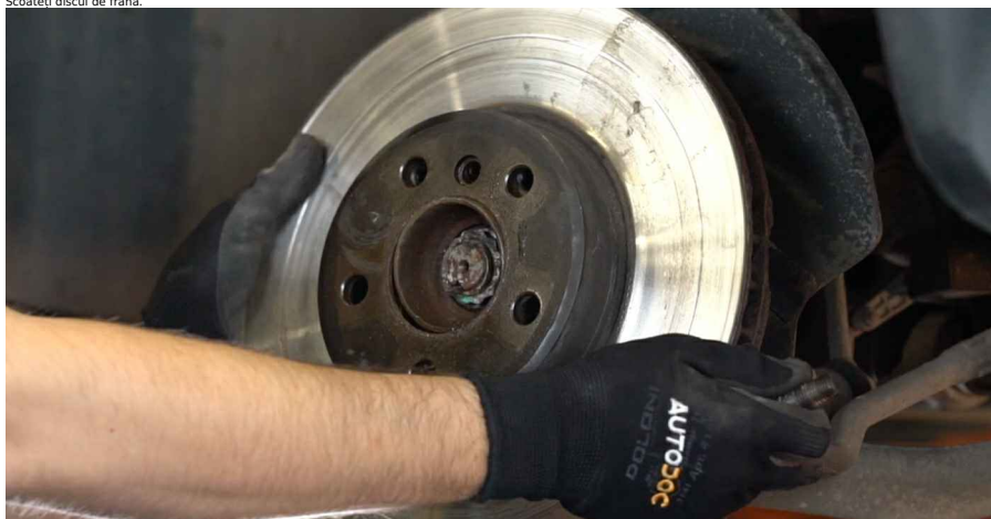
22 Curățați butucul roții. Folosiți o perie de sârmă. Tratați suprafața de contact. Folosiți unsoare de cupru.
