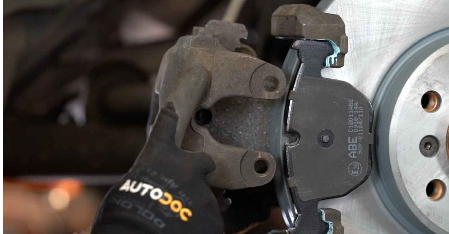
31 Instalati sigurantele manșoanelor ghidajelor etrierului.
