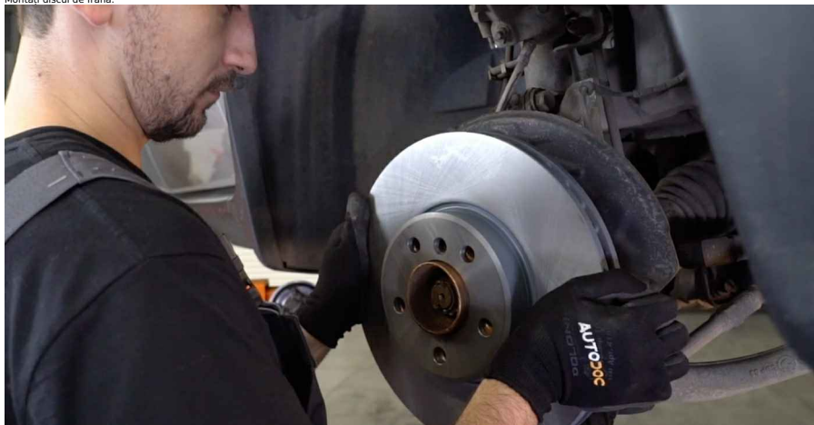
24 Strângeți fixarea discului de frână. Folosiți Torx T30. Folosiți o cheie de cuplu. Strângeți pînă la cuplul de 16 Nm.
