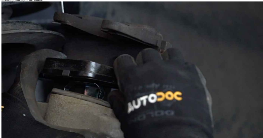
30 Montați etrierul de frână și fixați-l. Folosiți cheia hexagonală nr. H7. Folosiți o cheie de cuplu. Strângeți pînă la cuplul de 30 Nm.
