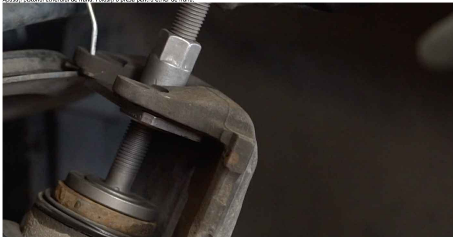
28 Curătați locurile de montare ale etrierului de frână și suportul acestuia. Folositi o perie de sârmă. Folositi un spray curățare frâne.
