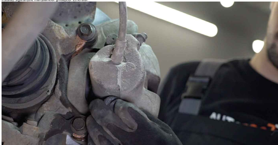
32 Montati arcul de fixare a etrierului de frână.
