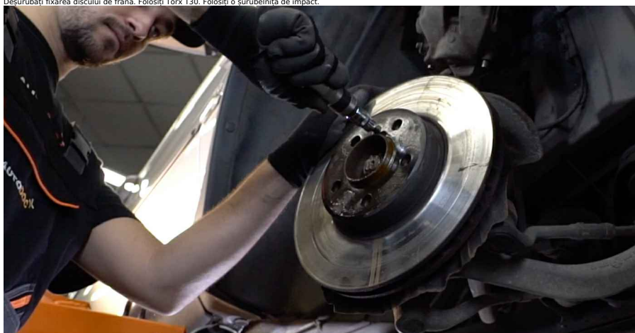
21 Înlocuirea discului de frână - BMW X5 E53. Sfatul util: • Dacă e nevoie, folosiți un ciocan cu cap moale.
