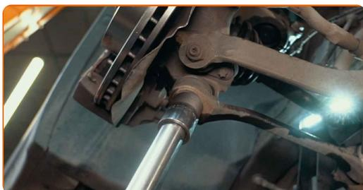
**47** Înșurubați elementul de fixare ce unește brațul de control cu subcadrul. Utilizați o cheie în combinație fixă №16. Utilizați o cheie tubulară №18. Folosiți o cheie cu clichet.
