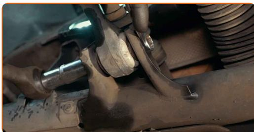
**48** Strângeți elementele de fixare care unesc brațul de control și subcadrul. Utilizați o cheie în combinație fixă №16. Utilizați o cheie tubulară №18. Folosiți o cheie de cuplu. Strângeți pînă la cuplul de 110 Nm.
