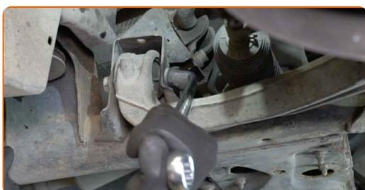
**21** Strângeți elementul de fixare față ce unește brațul de control cu subcadrul. Utilizați o cheie în combinație fixă №21. Folosiți o cheie de cuplu. Strângeți pînă la cuplul de 110 Nm.+120°
