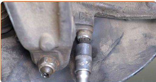
**8** Deșurubați elementul de fixare ce conectează rotula suspensiei la brațul de control al suspensiei. Utilizați o cheie tubulară №21. Folosiți o cheie cu clichet.
