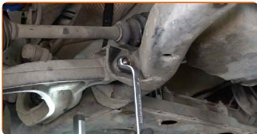
**20** Înșurubați elementul de fixare din spate, care unește brațul de control la subcadru. Utilizați o cheie în combinație fixă №21.
