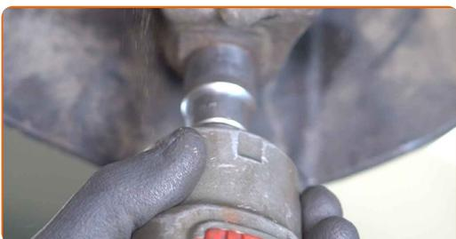
**9** Deșurubați elementul de fixare anterior al brațului. Utilizați o cheie în combinație fixă №21.
