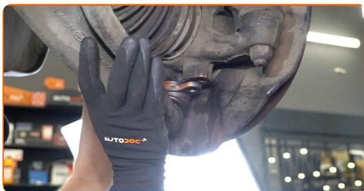
**16** Înșurubați elementul de fixare ce unește articulația sferică de portfuzetă. Utilizați o cheie tubulară №19. Folosiți o cheie cu clichet.
