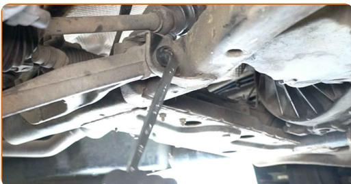
**10** Deșurubați elementul de fixare din spate, ce conectează brațul de control la subcadru. Utilizați o cheie în combinație fixă №21.
