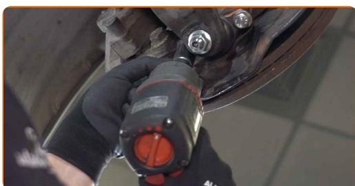
**17** Înșurubați elementul de fixare care unește articulația sferică la brațul de comandă. Utilizați o cheie tubulară №21. Folosiți o cheie cu clichet.
