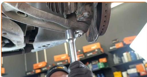
**19** Înșurubați elementul de fixare ce unește brațul de control cu subcadrul. Utilizați o cheie în combinație fixă №21.
