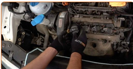
21 Luați laveta din microfibră de pe corpul clapetei de accelerație.
