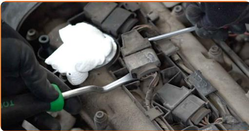
11 Scoateți bobina de inducție din spațiul pentru bujii.
