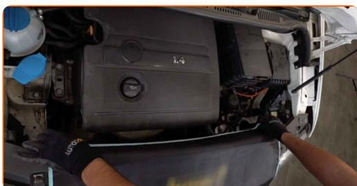
3 Desprindeți din partea stângă furtunul de ventilare al carterului de la capacul motorului.
