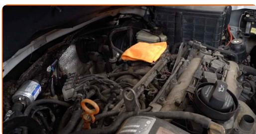
6 Desprindeți furtunul de ventilare al carterului de la gâtul de umplere ulei.
