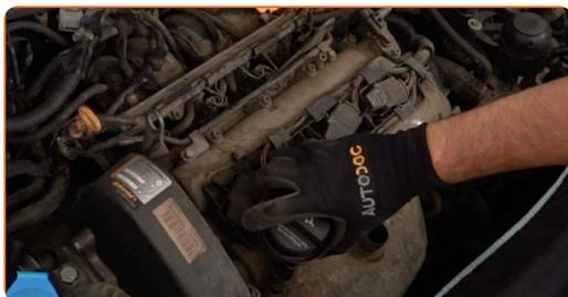
8 Acoperiți orificiul de umplere ulei cu o lavetă din microfibră, pentru a preveni pătrunderea murdăriei și obiectelor străine în interiorul sistemului.
