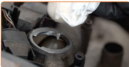
19 Instalați gâtul de umplere ulei. Înșurubați gâtul de umplere ulei.
