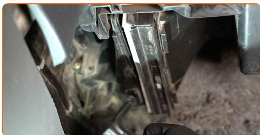
**5** Îndepărtați din carcasa filtrului elementul de filtrare care urmează să fie înlocuit.
