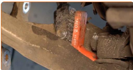
21 Deșurubați elementul de fixare inferior al barei de sprijin amortizor. Utilizați o cheie tubulară №18. Utilizați o cheie în combinație fixă №18.
