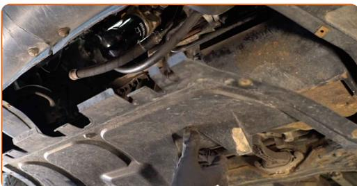
**7** Așezați un vas cu capacitate de cel puțin 5 litri pentru uleiul uzat sub orificiul de scurgere.
