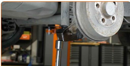
**8** Înşurubaţi elementul de fixare inferior al amortizorului. Utilizaţi o cheie în combinaţie fixă №16. Utilizaţi o cheie tubulară №16. Folosiţi o cheie cu clichet.
