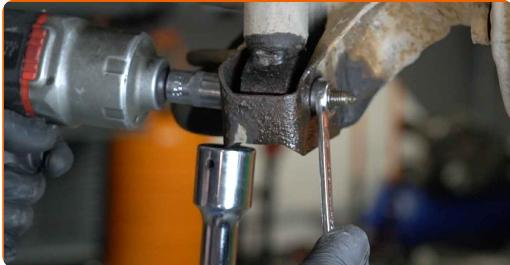
**9** Deşurubaţi elementul de fixare superior al amortizorului. Utilizaţi o cheie tubulară №16. Folosiţi o cheie cu clichet.
