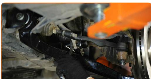
**13** Strângeți elementul de fixare ce unește bieleta antiruliu de telescopul amortizorului. Utilizați o cheie tubulară №19. Folosiți o cheie de cuplu. Strângeți pînă la cuplul de 60 Nm.+45°
