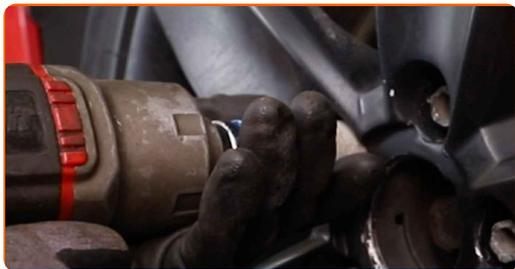
**43** Așezați din nou vehiculul la sol și, lucrând în ordine încrucișată, strângeți șuruburile de fixare ale roții. Folosiți o cheie tubulară de impact pentru roată #17. Folosiți o cheie de cuplu. Strângeți pînă la cuplul de 120 Nm.
