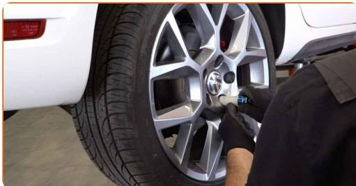
**31** Așezați din nou vehiculul la sol și, lucrând în ordine încrucișată, strâneți șuruburile de fixare ale roții. Folosiți o cheie de cuplu. Strângeți pînă la cuplul de 120 Nm.
