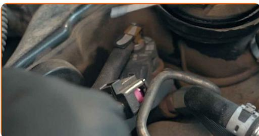
**8** Decuplați conectoarele de cabluri ale bujiilor incandescente. Utilizați cleștele cu vârful ascuțit.
