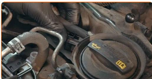
**20** Cuplați cablajul motorului.
