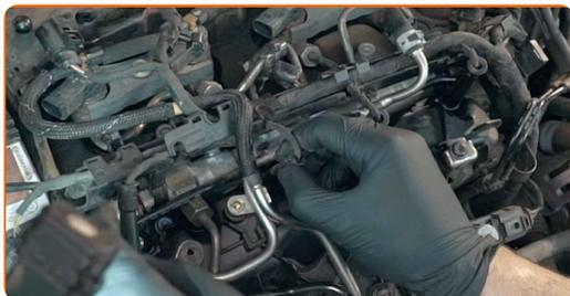
**18** Tratați conectorii cablajului motorului. Folosiți vaselină dielectrică.
