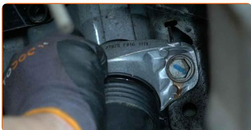
**36** Strângeți elementele de fixare ale suportului amortizorului. Utilizați o cheie tubulară №16. Folosiți o cheie de cuplu. Strângeți pînă la cuplul de 50 Nm.+45°
