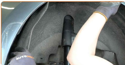
**42** Înșurubați elementele de fixare ale protectorului interior al roții. Folosiți Torx T25. Folosiți o cheie cu clichet.
