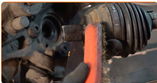
**55** Montați arborele de transmisie în interiorul butucului roții.
