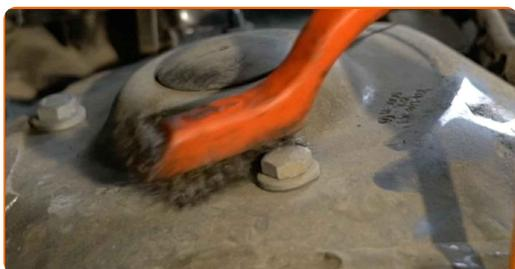
**7** Slăbiți elementele de fixare superioare ale suportului amortizorului. Utilizați o cheie tubulară №13. Folosiți o cheie cu clichet.
