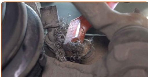
9 Deşurubaţi dispozitivul de fixare a senzorului ABS. Folosiţi cheia hexagonală nr. H5. Folosiţi o cheie cu clichet.
