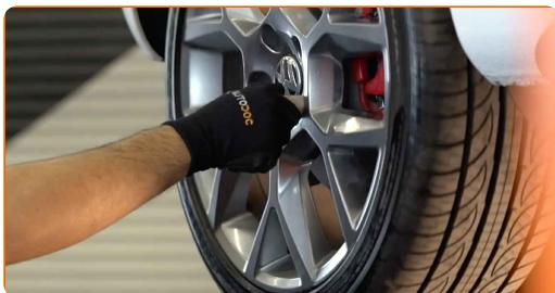
**19** Așezați din nou vehiculul la sol și, lucrând în ordine încrucișată, strâneți șuruburile de fixare ale roții. Folosiți o cheie de cuplu. Strângeți pînă la cuplul de 120 Nm.
