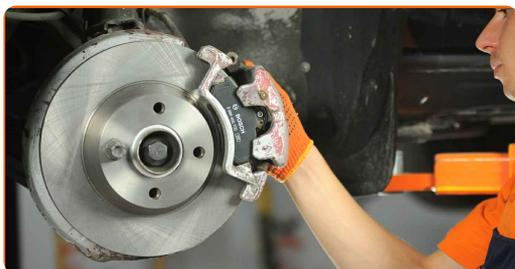
**17.2** Utilizați o cheie în combinație fixă №15. Utilizați o cheie tubulară №13. Folosiți o cheie de cuplu. Strângeți pînă la cuplul de 35 Nm.
