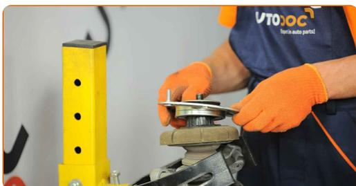
**28** Strângeți șurubul tijei pistonului barei de sprijin amortizor. Utilizați o cheie în combinație fixă №21. Folosiți Torx T50. Folosiți o cheie de cuplu. Strângeți pînă la cuplul de 70 Nm.
