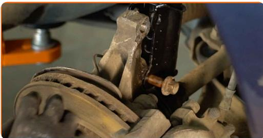
**41** Instalați șuruburile de fixare.
