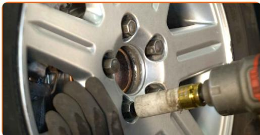
**23** Așezați din nou vehiculul la sol și, lucrând în ordine încrucișată, strângeți șuruburile de fixare ale roții. Folosiți o cheie de cuplu. Strângeți pînă la cuplul de 110 Nm.
