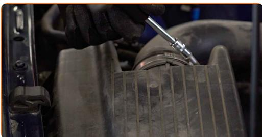
**5** Deconectați furtunul de alimentare cu aer de carcasa filtrului.
