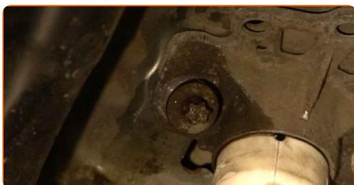
**28** Înșurubați elementul de fixare de sus al amortizorului. Utilizați o cheie tubulară №E16. Folosiți o cheie cu clichet.
