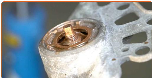
**26** Amplasați amortizorul sub aripa roții și fixați-l.
