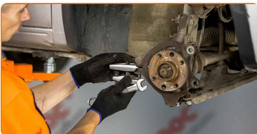
**17** Curățați elementele de fixare ale telescopului amortizorului. Folosiți o perie de sârmă. Folosiți spray WD-40.
