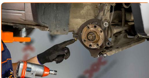
**15** Deșurubați piulița de fixare a capătului la fuzetă. Utilizați o cheie tubulară №16. Folosiți o cheie cu clichet.
