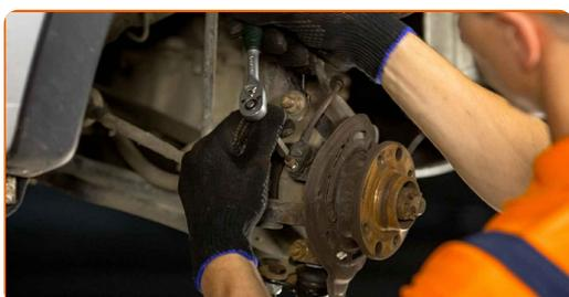
**13** Îndepărtați senzorul ABS de pe fuzetă.
