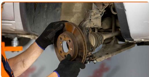
**12** Deșurubați suportul care fixează senzorul ABS pe fuzetă. Folosiți cheia hexagonală nr. H5. Folosiți o cheie cu clichet.
