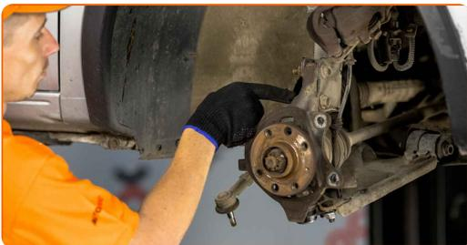
**18** Deșurubați elementul de fixare inferior al barei de sprijin amortizor. Utilizați o cheie în combinație fixă №18. Utilizați o cheie tubulară №18. Folosiți o cheie cu clichet.
