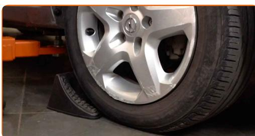
**3** Slăbiți șuruburile de fixare a roții. Folosiți o cheie tubulară de impact pentru roată #17.
