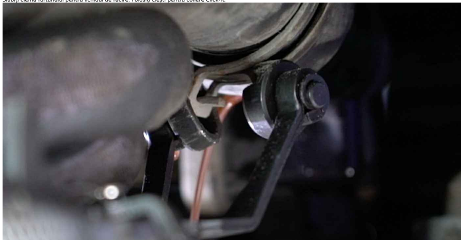
8 Desprindeți furtunul pentru lichidul de răcire.
