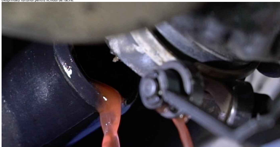
8 Desprindeți furtunul pentru lichidul de răcire.
