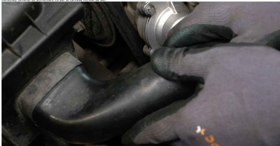
32 Fixați colierul de furtunul de admisie al filtrului de aer.
