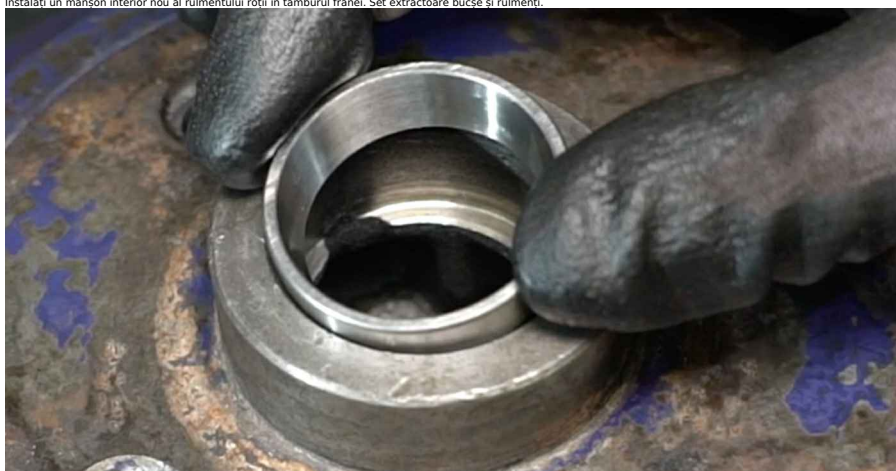
19 Instalați manșonul interior al rulmentului roții din tamburul de frână. Set extractoare bușe și rulmenți.
