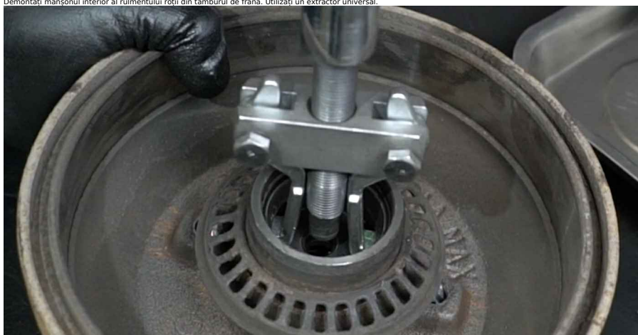
club.autotec24.ro 6-14 16 Demontați manșonul interior al rulmentului roții din tamburul frânei. Folosiți un set de extractoare buce și rulmenți.
