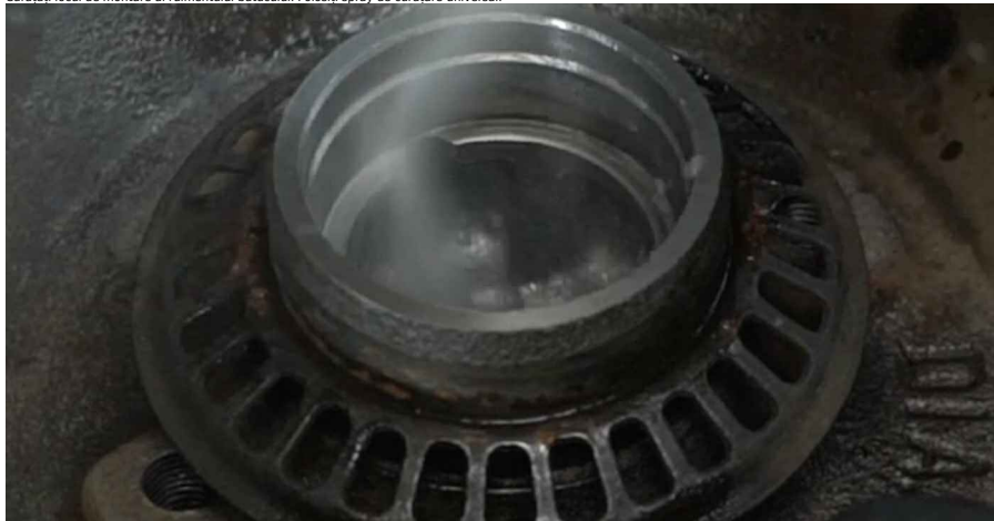
18 Instalați un manșon interior nou al rulmentului roții în tamburul frânei. Set extractoare bușe și rulmenți.
