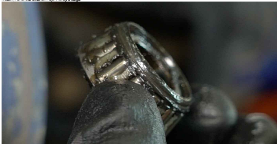
11 Scoateți tamburul de frână împreună cu rulmentul butucului de roată.
