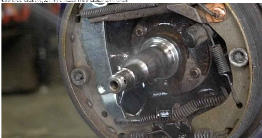
24 Instalați tamburul de frână asamblat cu rulmentul butucului roții.
