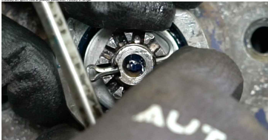
34 Montați capacul piulței butucului. Folosiți un ciocan de cauciuc.
