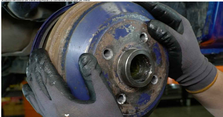
12 Înlocuirea: rulment roata - VAUXHALL Cavalier Mk2 Sedan (J82), Sfatul util de la AUTODOC:
