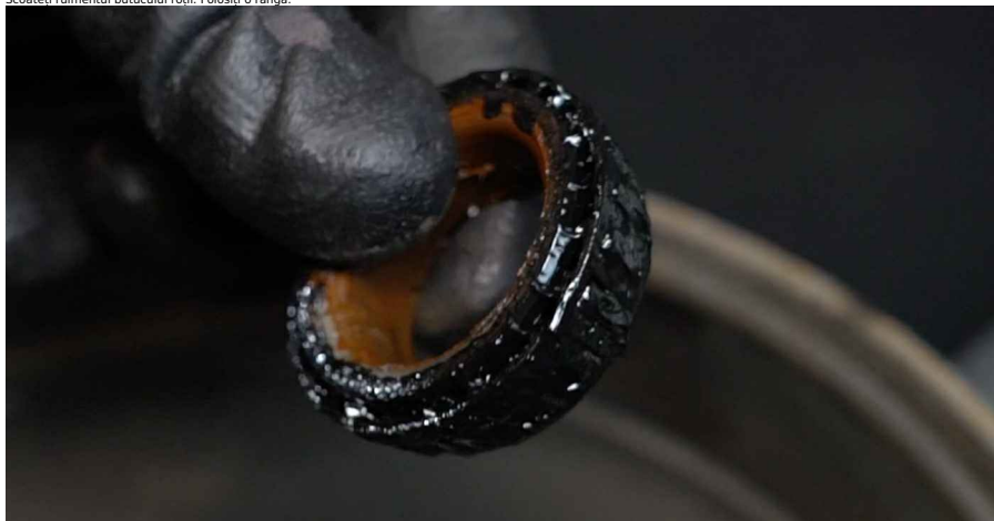
14 Curățați locul de montare al rulmentului butucului.
