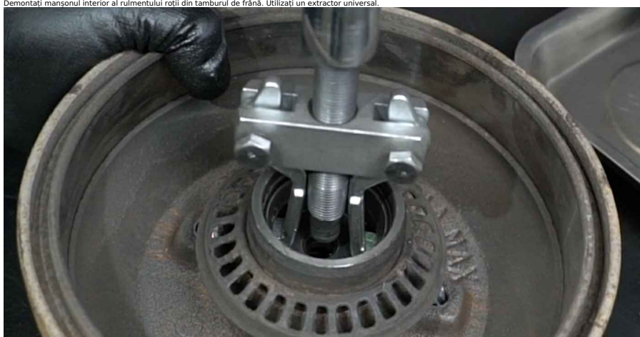
15 Demontați manșonul interior al rulmentului roții din tamburul de frână. Utilizați un extractor universal.
