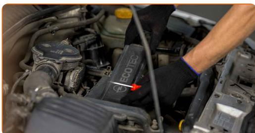
**5** Desfaceți conectorul de la bobina de inducție. Folosiți o șurubelniță dreaptă.
