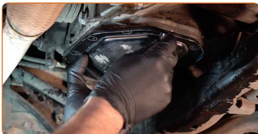
**18** Strângeți șuruburile de fixare ale băii de ulei a cutiei de viteze în cruce. Utilizați o cheie tubulară №11. Folosiți o cheie de cuplu. Strângeți pînă la cuplul de 20 Nm.
