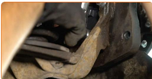
**35** Instalați suportul de fixare a furtunului de frână și cablul ABS. Utilizați o cheie tubulară №E8. Folosiți o cheie cu clichet.
