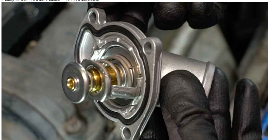
26 Instalați banda de cauciuc.
