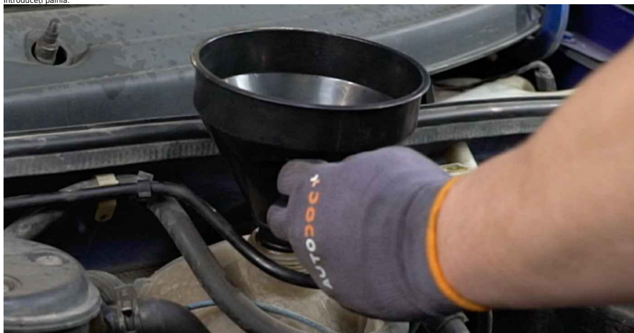
35 Turnați lichidul de răcire în rezervorul cu lichid de răcire.
