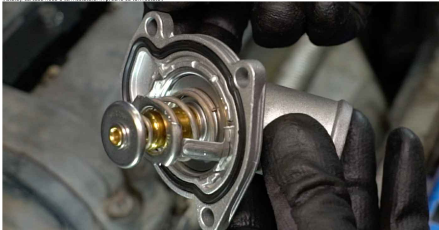
26 Instalați banda de cauciuc.
