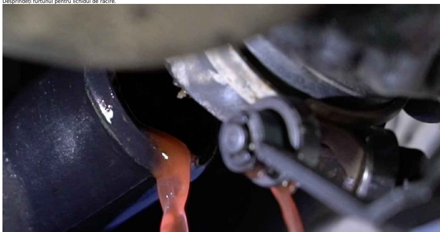
8 Desprindeți furtunul pentru lichidul de răcire.
