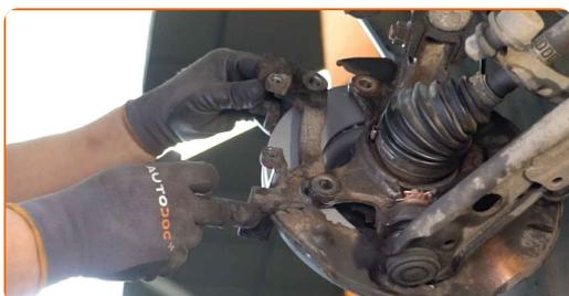
**23** Instalați șuruburile de fixare.
