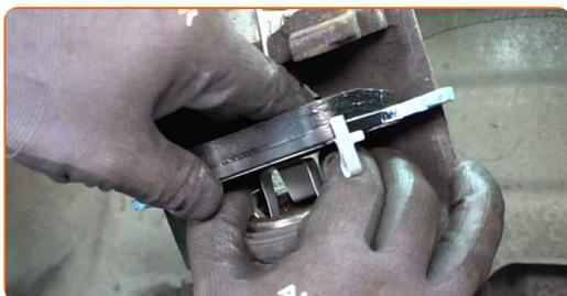
**29** Montați etrierul de frână și fixați-l.
