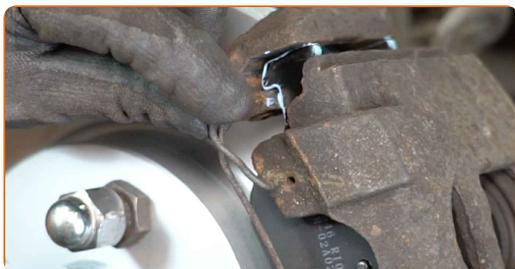
**33** Tratați suprafața unde discul de frână intră în contact cu janta. Utilizați lubrifiant ceramic.
