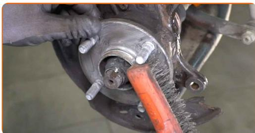
**19** Tratați suprafața de contact. Utilizați lubrifianț ceramic.
