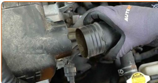
**5** Demontați capacul filtrului de aer.
