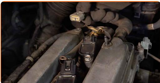
**6** Deconectați suportul de fixare al bobinei de inducție. Utilizați o cheie tubulară №10.
