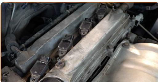
**8** Scoateți bobina de inducție din spațiul pentru bujii.
