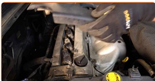
**5** Desprindeți conectorii de la bobinele de aprindere.
