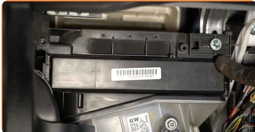
**7** Montați limitatorul de deschidere al torpedoului.
