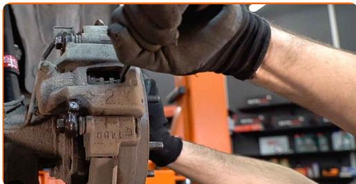
**9** Deșurubați fixarea etrierului de frână. Utilizați o cheie tubulară №17. Folosiți un port tarod.
