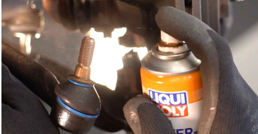
17 Conectați capul barei de direcție la fuzetă.
