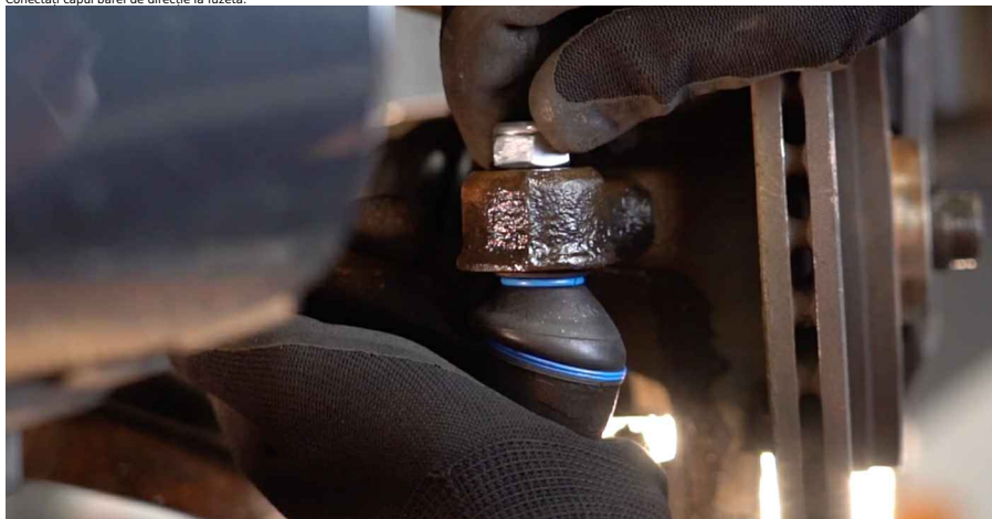
18 Strângeți piulița de fixare ce unește capul barei de direcție transversale la portfuzetă. Utilizați o cheie tubulară №17. Folosiți o cheie de cuplu. Strângeți până la cuplul de 33 Nm.
