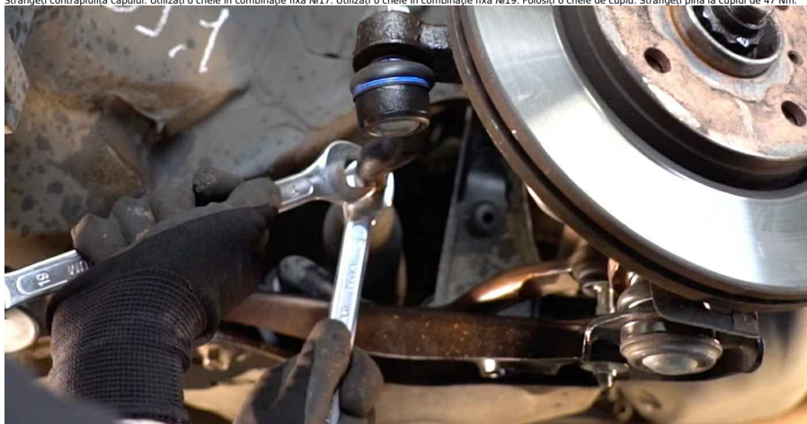
20 Instalați splintul care fixează suportul capului barei de direcție. club.autodoc24.ro 7-11
