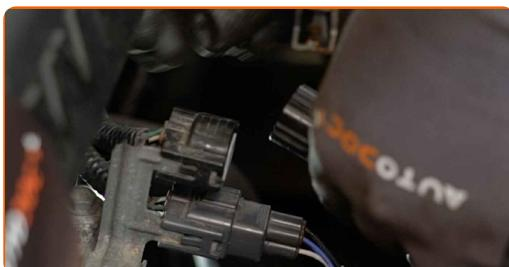
**4** Slăbiți colierul de fixare pentru a elibera fasciculul de cabluri al senzorului de oxigen. Folosiți o șurubelnită dreaptă.
