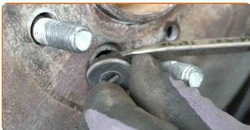
**21** Eliberați mecanismul de reglare al frânei de parcare. Folosiți o șurubelniță dreaptă.
