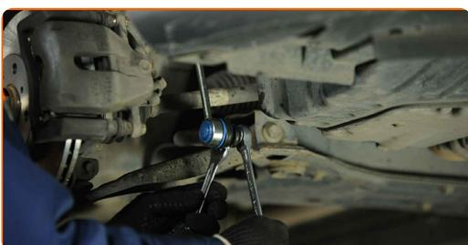
**13** Strângeți elementul de fixare ce unește bieleta antiruliu de telescopul amortizorului. Utilizați o cheie în combinație fixă №14. Folosiți cheia hexagonală nr. H6. Folosiți o cheie de cuplu. Strângeți pînă la cuplul de 50 Nm.
