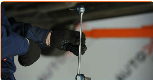
**12** Strângeți elementul de fixare ce unește bieleta antiruliu de bara stabilizatoare. Utilizați o cheie în combinație fixă №14. Folosiți cheia hexagonală nr. H6. Folosiți o cheie de cuplu. Strângeți pînă la cuplul de 50 Nm.
