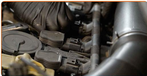
**5** Scoateți bobina de inducție din spațiul pentru bujii.
