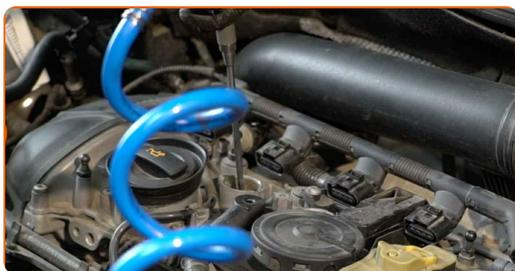
**7** Deșurubați bujiile. Folosiți o cheie tubulară pentru bujii #16. Folosiți o cheie cu clichet.
