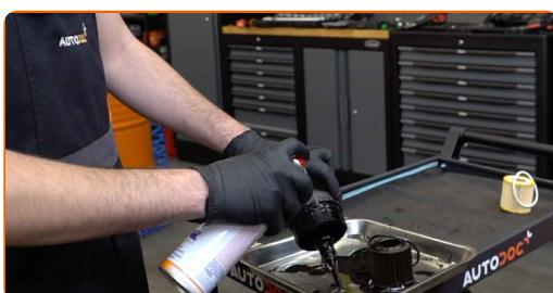
**20** Instalați un inel etanșator nou pe suportul acestuia de pe capacul filtrului.
