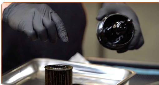
**18** Scoateți inelul etanșator al capacului filtrului de ulei. Folosiți o șurubelnită dreaptă.
