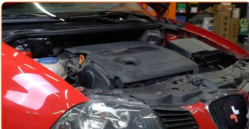
**4** Deșurubați elementele de fixare ale terminalelor acumulatorului. Utilizați o cheie tubulară №10. Folosiți o cheie cu clichet.
