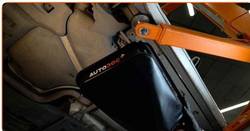
**5** Curătați elementele de fixare ale conductelor de alimentare cu combustibil. Utilizați o perie curățitoare din nylon. Folosiți spray de curățare universal.
