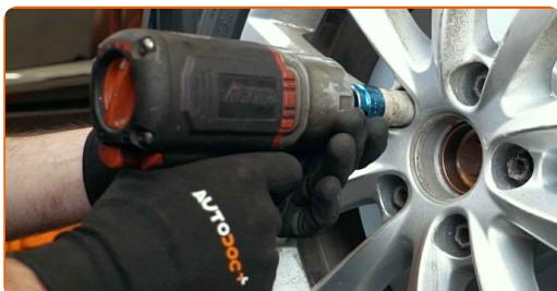
**21** Așezați din nou vehiculul la sol și, lucrând în ordine încrucișată, strângeți șuruburile de fixare ale roții. Folosiți o cheie tubulară de impact pentru roată #17. Folosiți o cheie de cuplu. Strângeți pînă la cuplul de 120 Nm.
